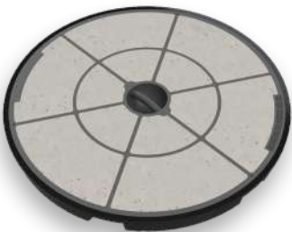
480.60BHrexo 486.60BHrexo Couvercle en fonte avec béton Classe D400/E600, poignée, antirotation Protection-rexo
