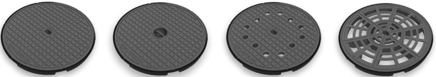
180.60rexo 186.60rexo Couvercle en fonte Classe D400/E600, trou de pic, antirotation Protection-rexo
