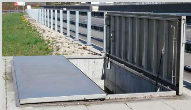
Couvercle KE en acier inoxydable, A15, à charnière avec aide à l'ouverture, dispositif de verrouillage, montage sur couronne murale
