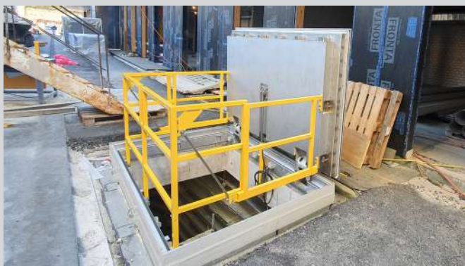
Acier inoxydable, remplissage de béton en usine, E600, articulé avec système hydraulique, garde-corps automatique, étanche, résistance au feu EI60, isolation pour réduire la condensation
