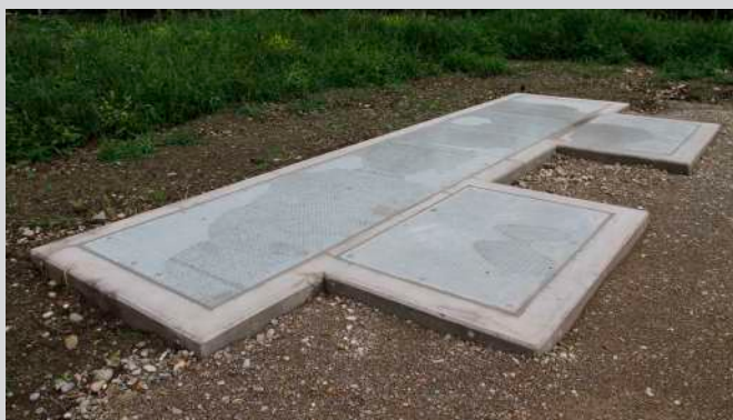
Acier galvanisé à chaud, surface en tôle larmée, D400, à soulever, vissé, étanche au refoulement 0,3 bar
