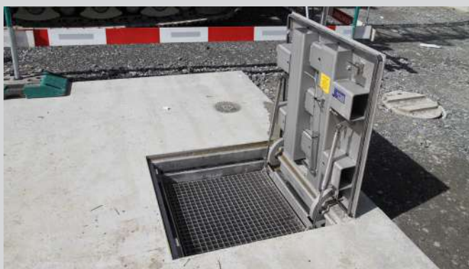
Acier inoxydable, surface en tôle larmée, D400, articulé avec aide à l'ouverture, sécurité anti-chute, verrouillé, étanche à l'eau
