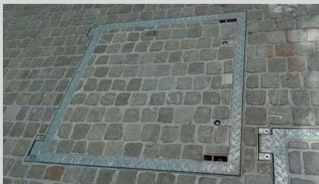
Acciaio zincato a caldo, lastricabile come il selciato, C250, incernierato con ausilio per l'apertura, a tenuta stagna
