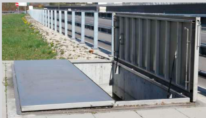
Chiusino KE in acciaio inox, A15, incernierato con ausilio per l'apertura, bloccaggio del fermo, montaggio su corona murale
