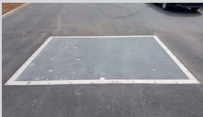
Acciaio inox, riempimento con calcestruzzo e colorazione in fabbrica, D400, predisposto per il sollevamento, avvitato, a tenuta stagna
