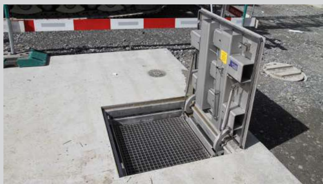
Acciaio inox, superficie in lamiera bugnata, D400, incernierato con ausilio per l'apertura, sistema di sicurezza anticaduta, bloccato, a tenuta stagna
