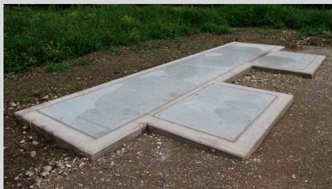
Acciaio zincato a caldo, superficie in lamiera bugnata, D400, predisposto per il sollevamento, avvitato, a prova di ristagno 0,3 bar
