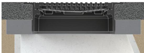
4. Nettoyer la surface du cadre et s'assurer de la propreté des appuis. Avant le compactage, veillez à ce que la colle-rette de la grille soit bien appuyée. Ensuite, passer avec le compacteur sur la grille (avec la protection en tôle) en même temps que sur la chaussée, pour obtenir son scellement définitif. Veillez à compacter la grille de façon homogène sur tout son pourtour.
