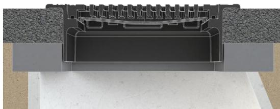
3. Enlever la couche d'enrobé sur le tampon. Retirer la grille. Relever le cadre à l'aide de deux pics et le caler en bourrant avec de l'enrobé sous la colle-rette du cadre de manière régulière et compacte. La grille doit se situer légèrement au-dessus de la couche de support.
