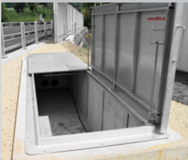
Coperchi KE in acciaio inox V4A calpestabile, 2 sezioni apribili, a tenuta stagna. Apertura 400 x 100 cm.
