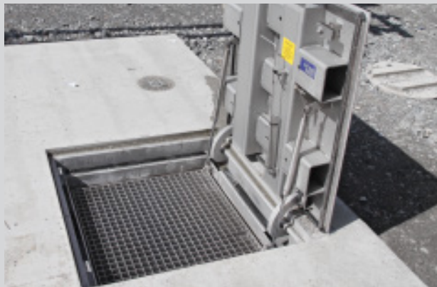
Coperchi in acciaio inox V4A superficie antiscivolo, classe D400 con ausilio di apertura e protezione anticaduta. Apertura 80 x 80 cm.
