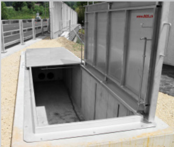
Regard KE en acier inoxydable V4A praticable, en 2 parties, rabattable, étanche aux eaux de ruissellement. OL 400 x 100 cm.
