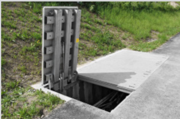
Regard en acier inoxydable V2A, surface en tôle larmée, classe D400 avec aide à l'ouverture, 4 parties, étanche aux eaux de ruissellement. OL 400 x 150 cm.
