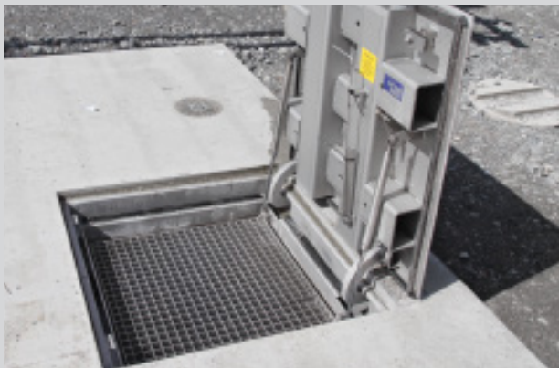
Regard en acier inoxydable V4A, surface en tôle larmée, classe D400 avec aide à l'ouverture et protection antichute. OL 80 x 80 cm.
